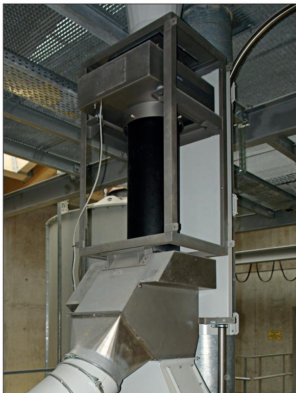
*Séparateur de métaux RAPID DUAL en protection de machine lors de la fabrication de pellets.*
