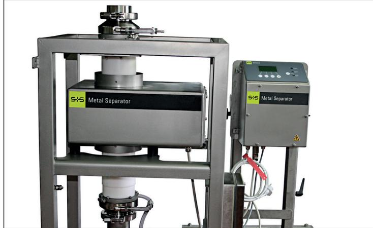
Détecteur de métaux P-SCAN RG intégré dans une conduite de transport, par exemple pour le contrôle qualité de chocolat liquide. (ancienne version)
