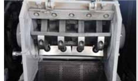
Les broyeurs GST sont conçus pour le recyclage en flux tendu de pièces volumineuses comme des bidons, bouteilles et autre flaconnages issus du soufflage.
