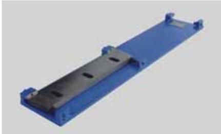
Les lames mobiles et fixes sont pré-réglées sur un gabarit à l'extérieur de la machine avant l'installation. Ceci rend l'ajustement aisé à l'intérieur de la machine.
