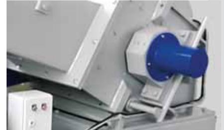
Les paliers très résistants sont séparés de la chambre de coupe pour éviter toute infiltration de graisse dans la matière et toute défaillance des roulements due à une contamination provenant de la chambre de coupe.
