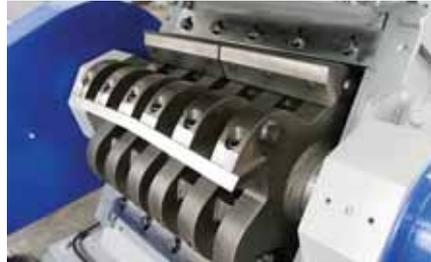
La technologie spéciale de ce rotor tire automatiquement les tubes ou les profilés dans la chambre de coupe, cette conception ajuste automatiquement le chargement.
