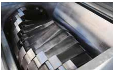
Les lames rotors décalées créent une coupe séquencée, ce qui augmente le couple de broyage. Toutes les machines de la gamme GSL sont adaptées aux matériaux solides et souples.
