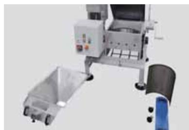
Grâce au système "Ouverture Rapide" de ZERMA utilisé sur la série GSL, ces machines peuvent être ouvertes rapidement pour le nettoyage et la maintenance sans la nécessité d'outils particuliers/spéciaux.
