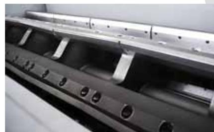
La série GSH 1100 est standardisée avec des rotors de type H équipés de 9, 11 ou 13 rangées de lames pour garantir une capacité optimale.
