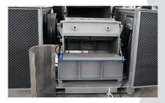
Afin de minimiser l'espace au sol nécessaire et pour rendre la machine facile à déplacer, les commandes et l'armoire électrique sont intégrés dans l'insonorisation.
