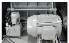
Pour rester dans la même état d'esprit d'une gamme compacte, l'ouverture est motorisée et hydraulique pour atteindre le caisson d'insonorisation.
