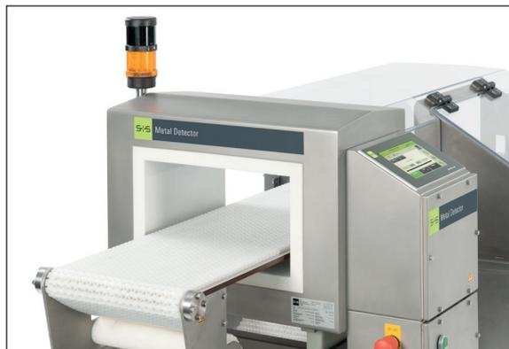
*Détecteur de métaux GLS: contrôle de gâteaux en sortie.*
