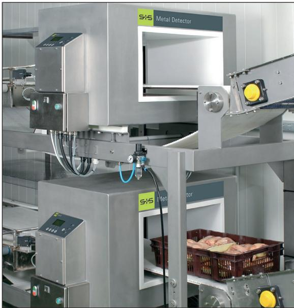
*Détecteurs de métaux GLS montés sur deux lignes de production pour analyser des volailles*
