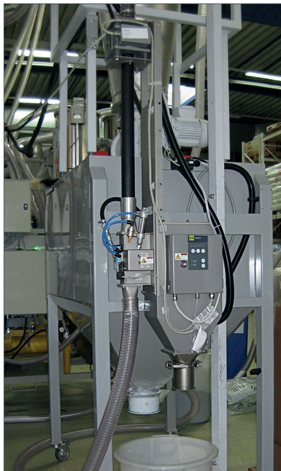
Exemple: Séparateur de métaux GF intégré dans une conduite pneumatique verticale (ancienne version)
