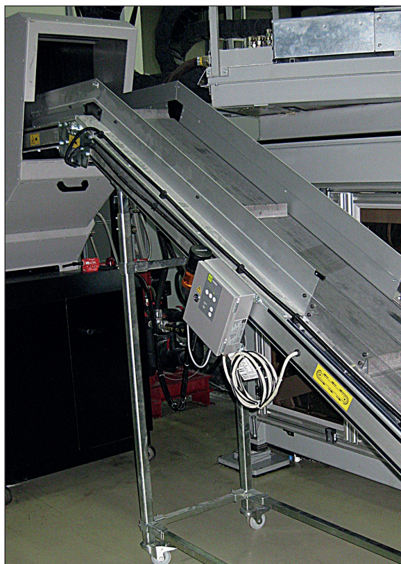
Exemple: Protection des broyeurs. Détecteur de métaux plat ELCON intégré dans le convoyeur d'alimentation du broyeur. (ancienne version)
