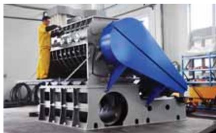
Les broyeurs peuvent être fabriqués pour répondre à diverses applications, par exemple avec un bac d'aspiration surdimensionné pour des débits pouvant atteindre 15T/H.
