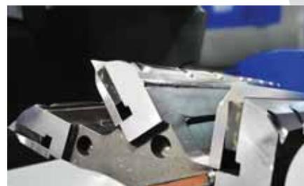
Pour des applications contenant des contaminations ou des charges abrasives les broyeurs GSH peuvent être équipés de rotors et de pièces maîtresses fabriquées en métaux hautement résistants, un revêtement HARD FACING peut être rapporté par soudure.
