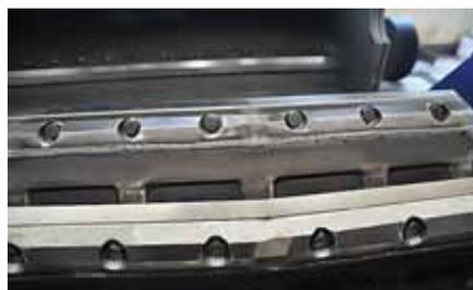
Les broyeurs GSH sont disponibles avec différentes technologies de rotors pour diverses applications, tous les rotors bénéficient de la technologie de coupe en V permettant une grande qualité de broyé.
