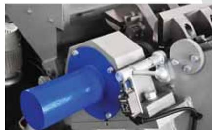
Les paliers très résistants sont séparés de la chambre de coupe pour éviter toute infiltration de graisse dans la matière et toute défaillance des roulements due à une contamination provenant de la chambre de coupe.
