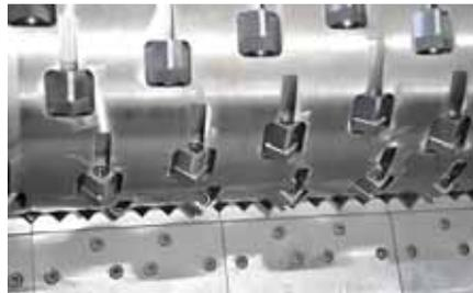
Tous les déchiqueteurs ZERMA sont équipés de notre rotor type E à surface plane. Les couteaux sont fixés sur des supports spéciaux qui sont vissés dans des logements usinés du rotor. Des options HARD FACING de traitement par soudure sont disponibles pour les applications abrasives.
