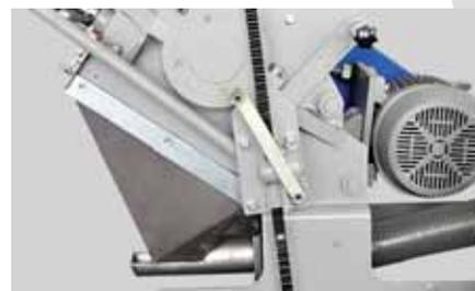
Le design des broyeurs série GSE permet un accès rapide et facile à la chambre de coupe pour l'entretien et le nettoyage.
