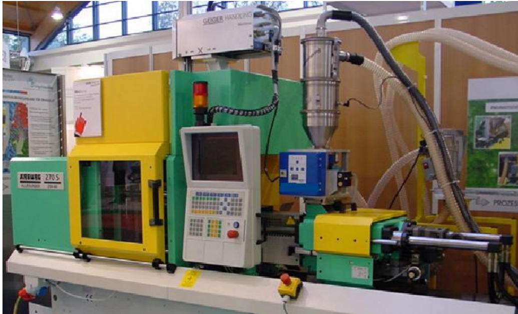
Compakt 50 DIGIT monté directement sur presse à injecter.
