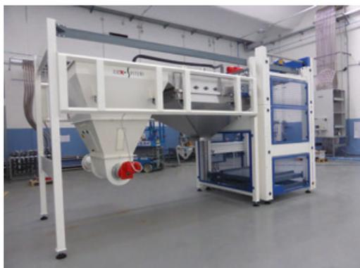
Les granulés de plastiques peuvent être déchargés directement dans des trémies ou acheminés vers des silos grâce à un système pneumatique de transport.
